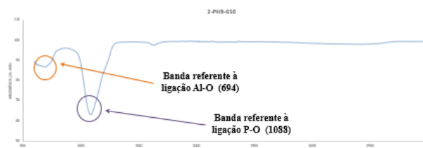
Figura 3. FTIR-IV obtida das nanopartículas de \text{AlPO}_4 sob banho de ultrassom após tratamento de 650°C.
